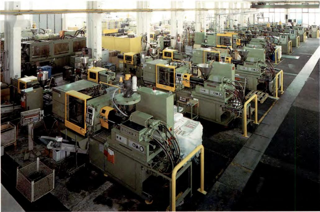
Im Grau Kunststoffwerk (oben) werden auf über 40 modernen Spritzgießmaschinen kleinste Präzisionsteile vom Bruchteil eines Grammes für die elektronische Industrie und bis zu 6,5 kg schwere technische Kunststoffteile für die Automobilindustrie hergestellt. Im Werk Grau Automation in Böhmekirch werden Roboteranlagen für große Datenarchive in Rechenzentren entwickelt und gebaut. Hier das automatische Bandkassetten-Bedienungssystem ABBA, Doppel-ABBA-System auf zwei Schienen mit Quadrotrium
