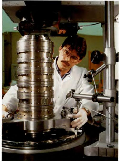
Endjustierung eines Objektivs für die Mikrolithographie zur Erzeugung von 0,5- $\mu\text{m}$ -Strukturen
