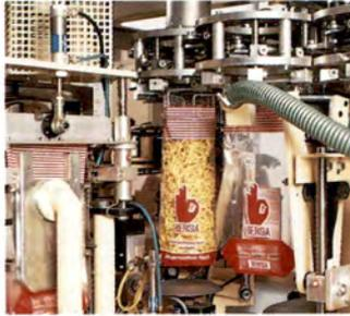
Auf automatischen Verpackungsanlagen werden die Produkte über Abfüllwaagen exakt gewogen und in dekorative Beutelpackungen abgefüllt und verschlossen. Die Nudel bleibt voll sichtbar.
