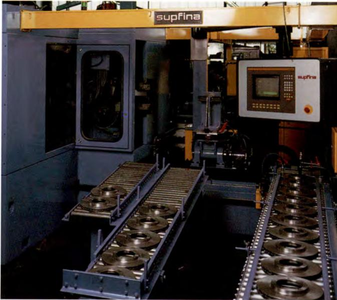
Schwäbische Hüttenwerke GmbH, Aalen. Fertigung innenbelüfteter Bremsscheiben (links).
