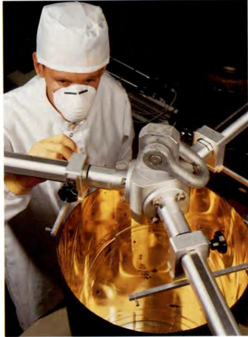
Für das Weltraumprojekt XMM der ESA (European Space Agency) wird Carl Zeiss drei Röntgenteleskope mit je 58 konzentrischen Leichtgewichtsspiegeln fertigen. Hier wird die Spiegelschale 40 zur Vermessung auf einer Koordinatenmeßmaschine vorbereitet.
